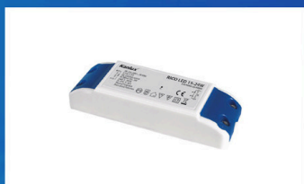
7301 RICO LED 15-24W működtető DC 700 mA (15-36V) 5....8 x 3W powerledhez
