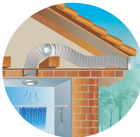
VKOk fan cottage ventilation example
